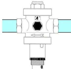
I riduttori di pressione serie EUROBRASS 143 PN40 non risentono, nel loro funzionamento, della forza di gravità; possono, quindi essere installati nell'impianto in qualsiasi posizione:
