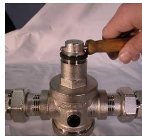
Tutti i riduttori di pressione Malgorani sono testati prima di essere imballati; durante il test essi vengono tarati in uscita alla pressione di 3 bar; la pressione di uscita può essere facilmente modificata una volta che il riduttore è installato sull'impianto.
